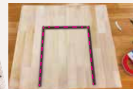
③カブセを両面テープで線に位置を調整しながら貼付け固定する
